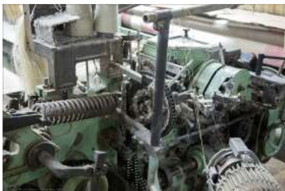
Станок СТБ-175 с накопителем утка «Iro-nova»
