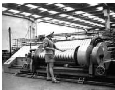
Формирование навоя на ленточной машине
