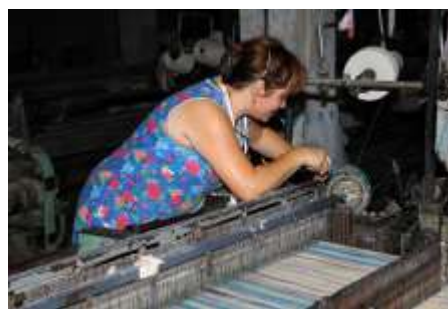
Ткацкий станок СТБ-175 с накопителем утка
