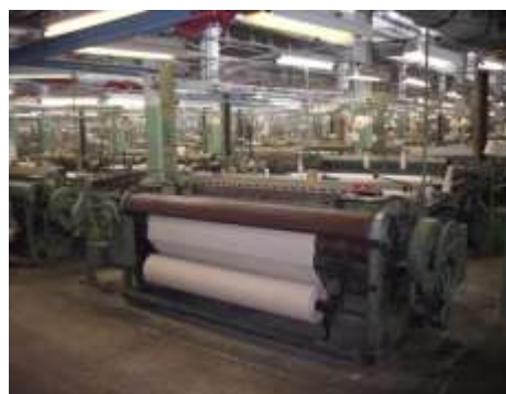
Ткацкие станки СТБ-175 освоенные на льнокомбинате им. И. Д. Зворыкина
